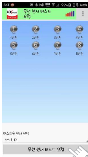
테스트 모드로 전환 할 센서 선택 후 무선센서 테스트 요청 터치
