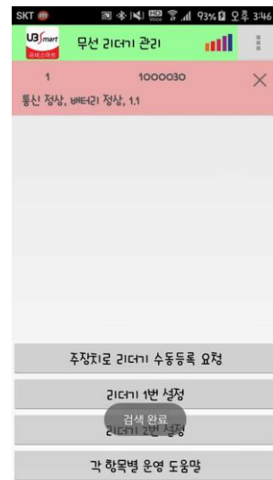
페어링 성공 리더기 ID 와 통신 상태, 배터리 상태, 리더기버전표시됨
